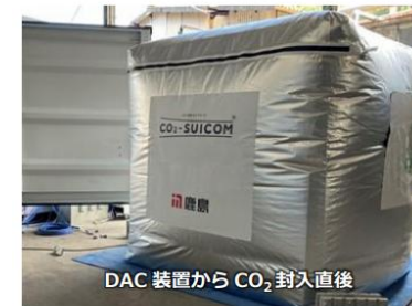
DAC 装置 (左) と炭酸化養生槽 (右)
