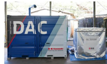
DAC 装置 (左) と炭酸化養生槽 (右)
