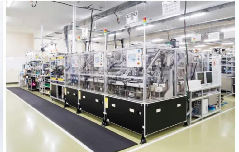
鈴鹿工場における低圧インバータの自動化ライン
