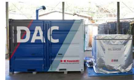
DAC 装置 (左) と炭酸化養生槽 (右)
