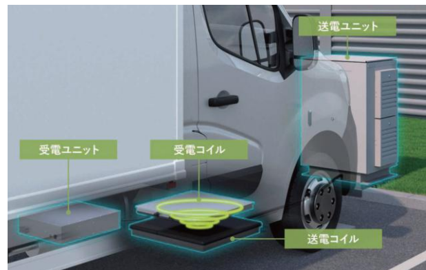
「EV用ワイヤレス急速充電システム (15kW)」開発
