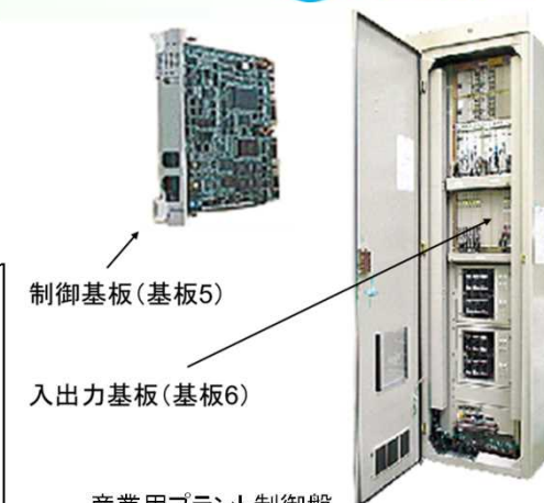
制御基板(基板5) 入出力基板(基板6) 産業用プラント制御盤 W×H×D: 600×2300×700mm
