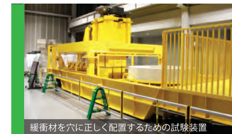
緩衝材を穴に正しく配置するための試験装置
