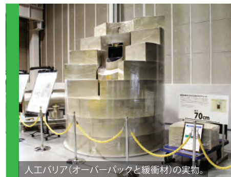
人工バリア(オーバーバックと緩衝材)の実物。
