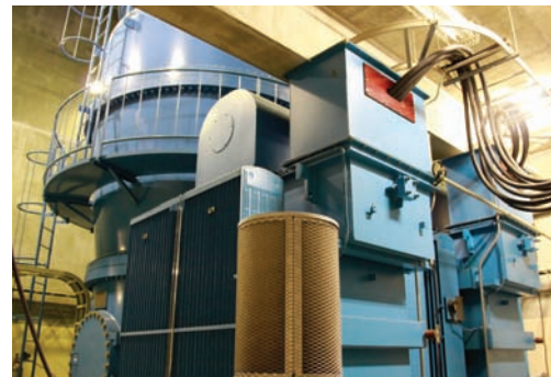
500万ボルトの高電圧で電子ビームを発生できる加速器。
