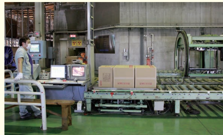
ローラーコンベヤーに載せられた医療用品は約20分で滅菌が完了する。
