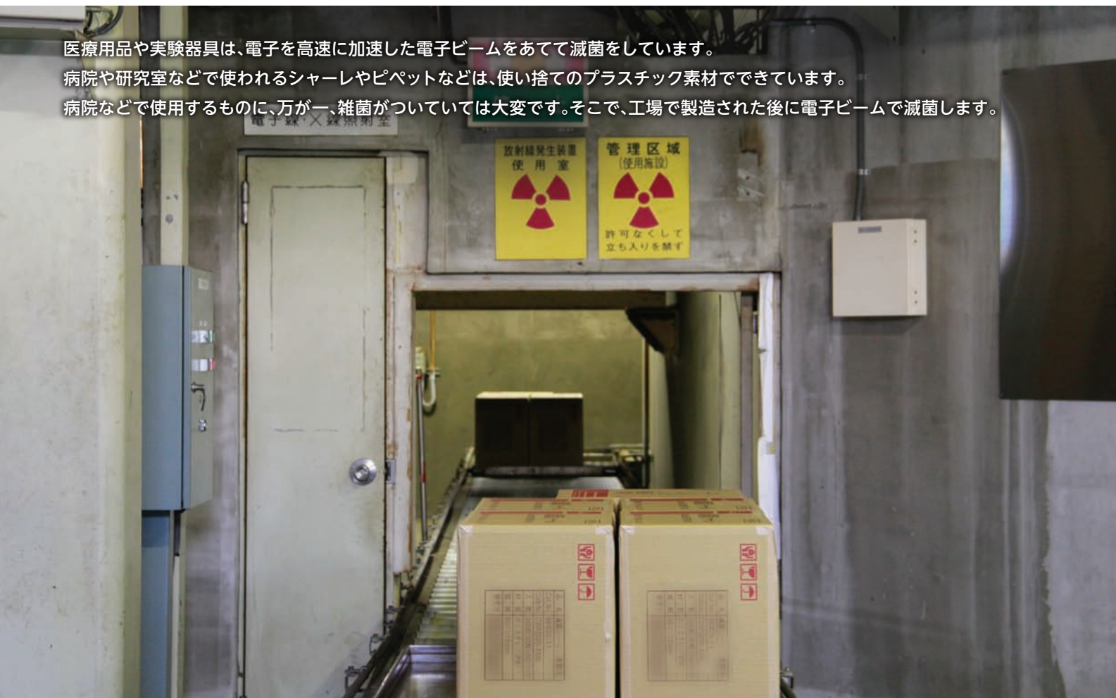
電子線による滅菌は商品を段ボールに詰めたままでも行うことができる。
