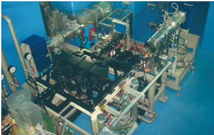
滅菌・殺菌用電子線加速器 (顧客 提供) 微生物を殺滅するための電子線を発生させる加速器。
