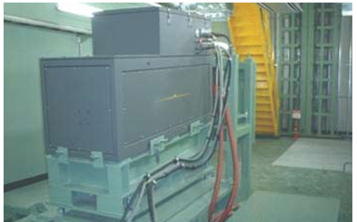
コンテナ貨物大型X線検査装置用加速器 (顧客 提供) 税関等で輸出入貨物を検査するためのX線を発生させる加速器。
