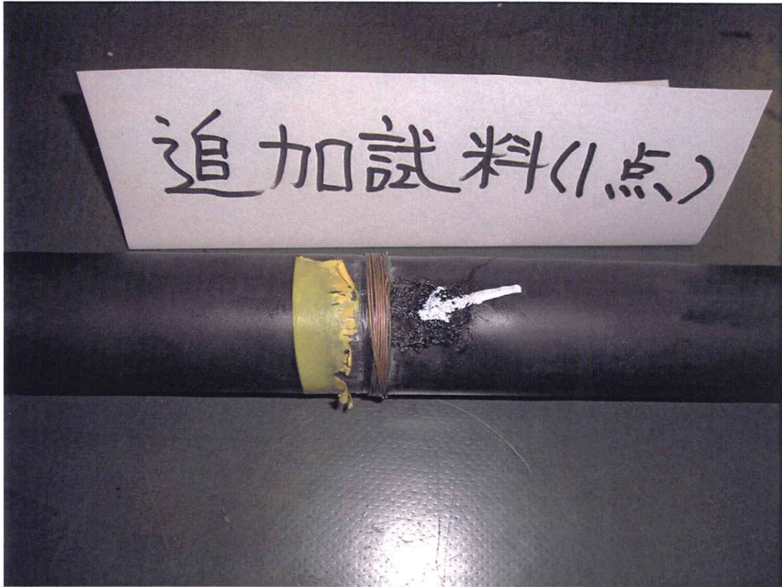
写真15 追加試料写真：棒状電極ではなく軟銅線をバインドしたものを電極とした。
