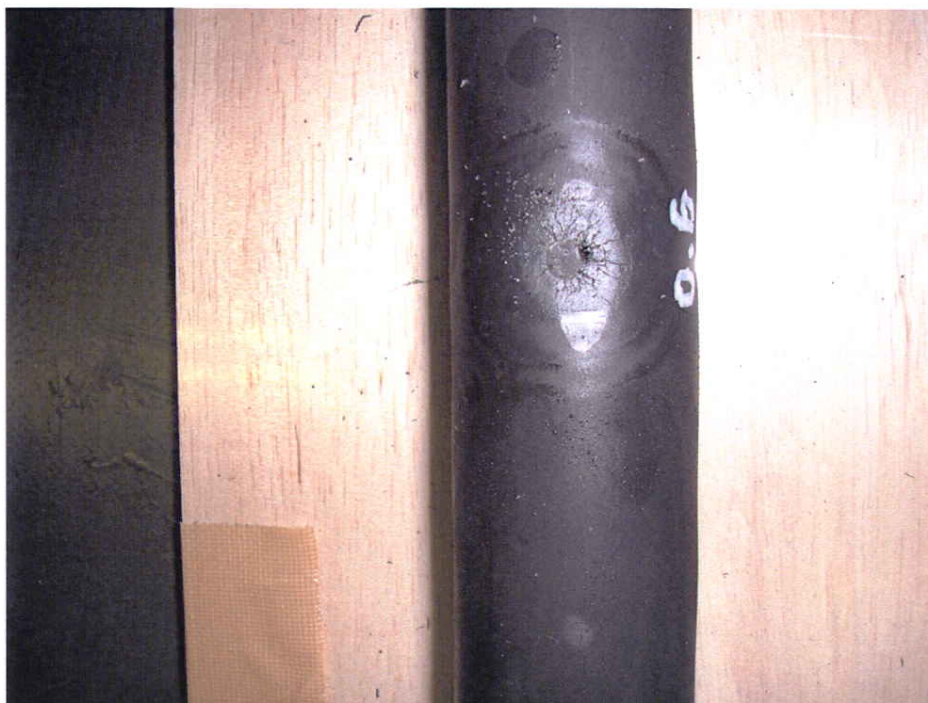
写真5 試料Aの破壊点（シース厚 2.5mm）の拡大写真 電極周囲は白くなっているが、フラッシュ発光のため判別しにくい。
