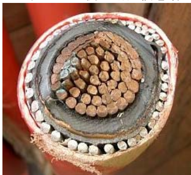
図3-4 高圧ケーブルの断面例
