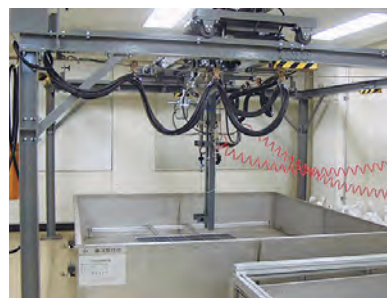
図10 太陽電池モジュールの試験例（降電試験）
