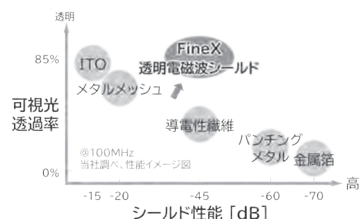
図6 電磁波シールド性能の比較
