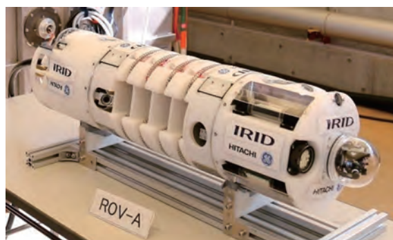
図1 原子炉格納容器内部詳細調査用 潜水機能付ポート型アクセス調査装置
