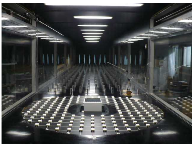
写真 11 風洞内に設置された実験模型 風下側より撮影 (勾配 \theta=40^\circ ,高さ 20\text{m} 相当)
