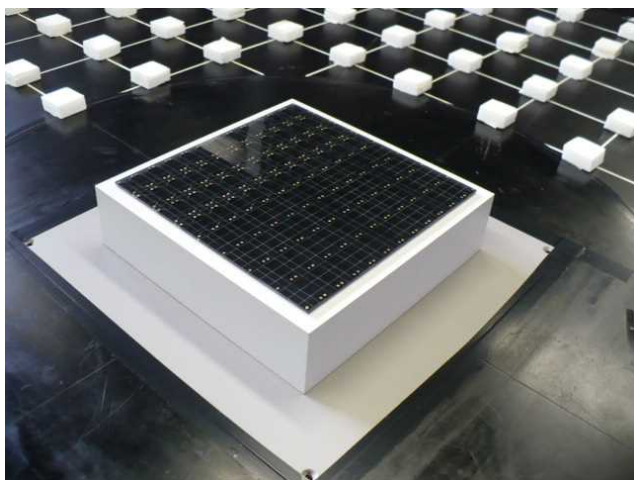
写真1 実験模型の外観 (勾配 \theta = 0^\circ ,高さ H=10\text{m} 相当)
