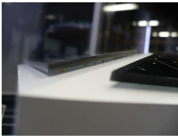
写真 16 パネルと屋根面との隙間の様子 (勾配 2.5 寸, 隙間 d=50\text{mm} 相当)
