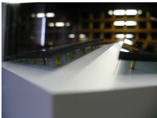
写真 18 パネルと屋根面との隙間の様子 (勾配 2.5 寸, 隙間 d=150\text{mm} 相当)
