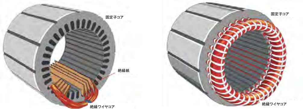
交流電動機の固定子
