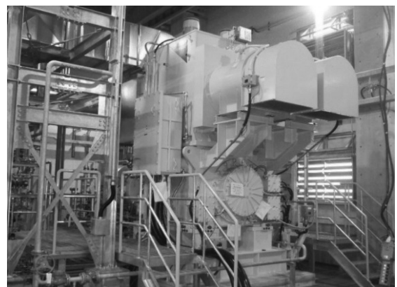
3300kW-8959 \text{min}^{-1} -磁気軸受採用 空冷誘導電動機
