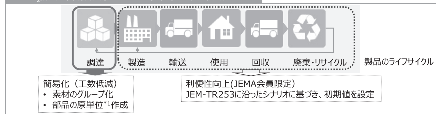
図1 LC-CO 2 排出量簡易算出手法の概要
