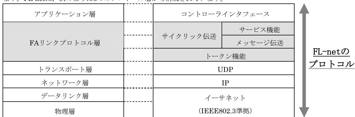
図 9.3-1 FL-netの基本構造
