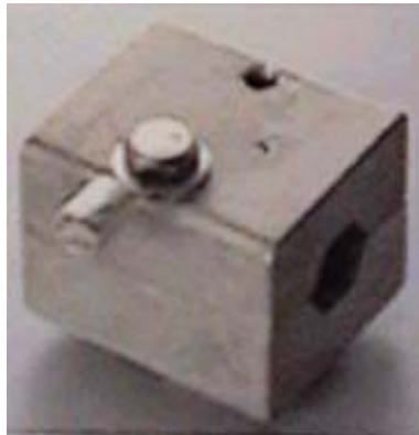
図 9.5-13 イーサネットの同軸ケーブルアース端子
