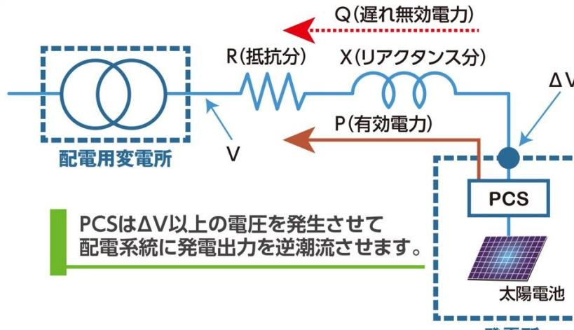
PCSは $\Delta V$ 以上の電圧を発生させて配電系統に発電出力を逆潮流させます。
