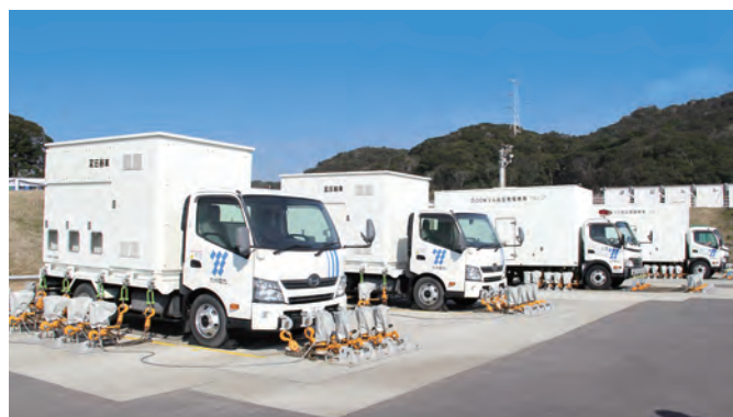
▲電源供給手段の多様化のための変圧器車と高圧発電機車
