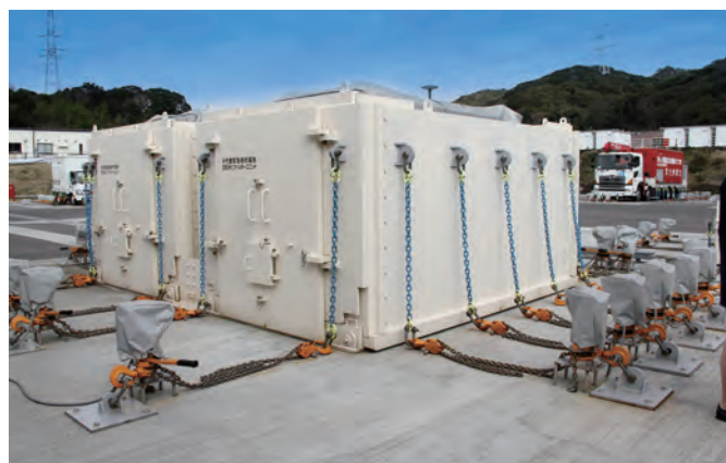
▲屋外の設備や車両は竜巻でも飛ばないよう鎖でつながれている(鎖のたるみは竜巻発生時に巻き取られ、張られた状態となる)
