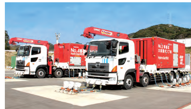
▲冷却手段多様化のために配備された移動式大容量ポンプ車
