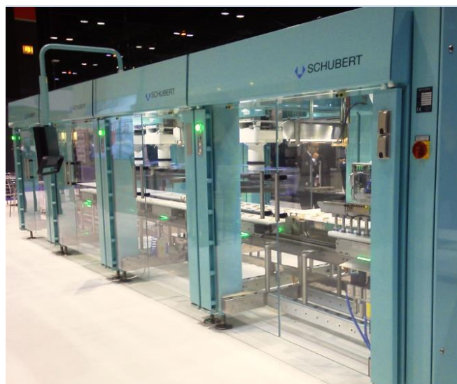
図 5-5 フレーム一体型制御盤の包装機(SCHUBERT 社)
