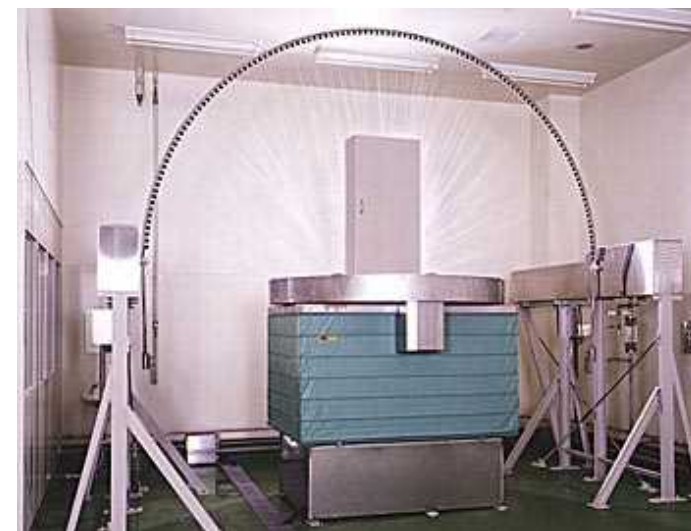
X3, X4(振動管試験設備)
